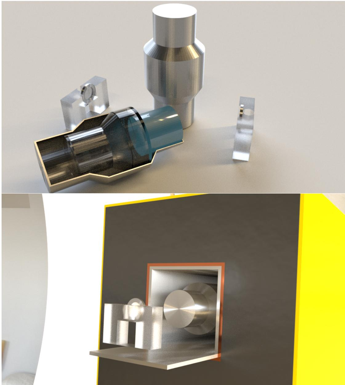
Abbildung 13: Simulierter Detektor mit Quellenhalterung, sowie aufgeschnittener Detektor (oben). Aufbau der Messanordnung der Simulation, vergleichbar mit Abbildung 5 (unten). Visualisierung durch das 3D-Programm Blender [13]
