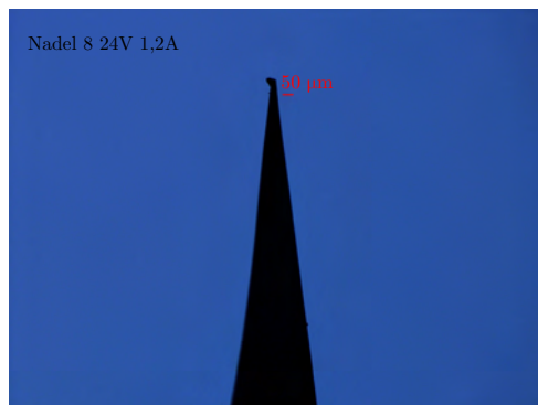
(o) Nadel 8 mit U_{max} = 24\text{ V} und I_{max} = 1,2\text{ A} Zulaufwinkel: 14,48^\circ Gesamteindruck: konkav
