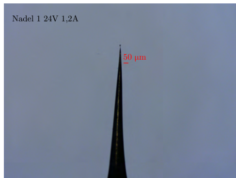
(a) Nadel 1 mit U_{max} = 24\text{ V} und I_{max} = 1,2\text{ A} Zulaufwinkel: 6,77^\circ Gesamteindruck: konkav
