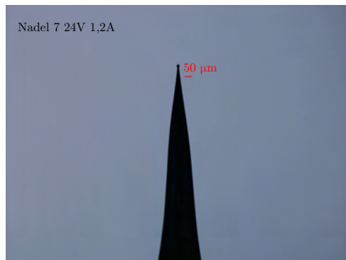
(m) Nadel 7 mit U_{max} = 24\text{ V} und I_{max} = 1,2\text{ A} Zulaufwinkel: 14,12^\circ Gesamteindruck: konvex
