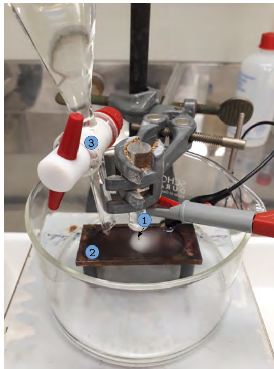
Abbildung 2.5: Aufbau zum Ätzen der Wolframnadeln
