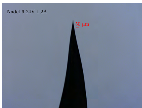
(k) Nadel 6 mit U_{max} = 24\text{ V} und I_{max} = 1,2\text{ A} Zulaufwinkel: 18,44^\circ Gesamteindruck: konvex
