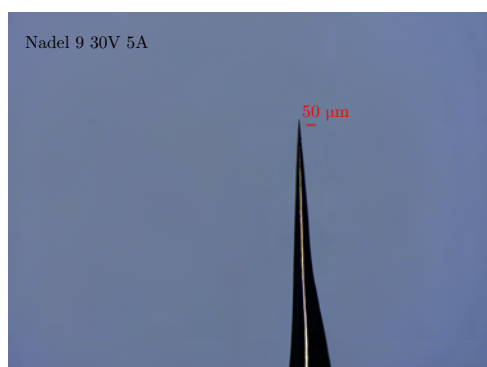
(q) Nadel 9 mit U_{max-Start} = 30\text{ V} und I_{max} = 5\text{ A} Zulaufwinkel: 7,85^\circ Gesamteindruck: konkav
