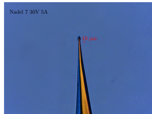
(n) Nadel 7 mit U_{max-Start} = 30\text{ V} und I_{max} = 5\text{ A} Spitze: mit Tropfen
