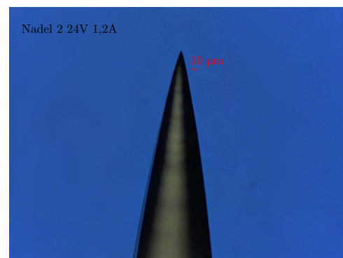
(d) Nadel 2 mit U_{max} = 24\text{ V} und I_{max} = 1,2\text{ A} Spitze: ohne Tropfen
