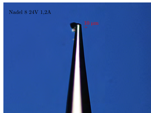
(p) Nadel 8 mit U_{max} = 24\text{ V} und I_{max} = 1,2\text{ A} Spitze: mit Tropfen
