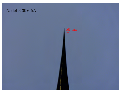
(e) Nadel 3 mit U_{max-Start} = 30\text{ V} und I_{max} = 5\text{ A} Zulaufwinkel: 10,31^\circ Gesamteindruck: konkav
