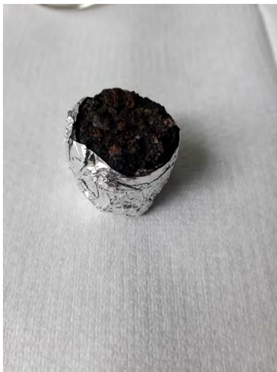
Abbildung 3.1: Der verwendete Asphaltbohrkern
