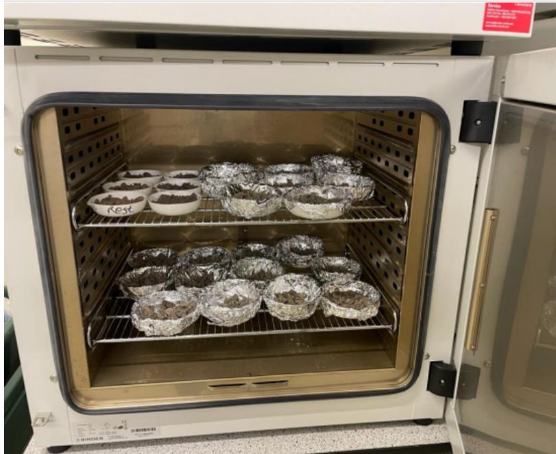
Abbildung 10: Die zerkleinerten Bodenproben, die sich in den Keramikschalen befinden, wurden in den Ofen gelegt und für mindestens 24 Stunden bei 105 Grad Celsius getrocknet. Die weißen Keramikschalen, ohne Aluminium, waren Versuchsproben für das Zersägen und Zerkleinern.
