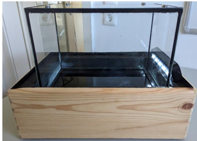
*Abbildung 9: Verwendete Nebelkammer [Saa23, S.16 Abb.10]*
