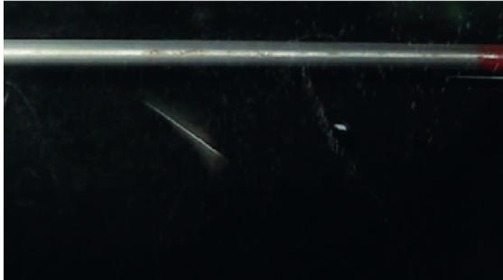
Abbildung 5: Alpha-Teilchen ausgehend von Thoriumstab
