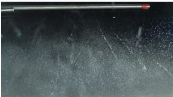
Abbildung 7: Beta-Teilchen ausgehend von Thoriumstab
