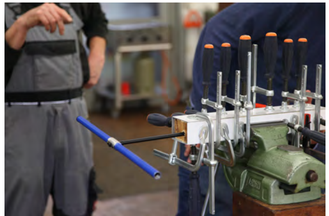
(d) Die Entnahme der Bohrkern
