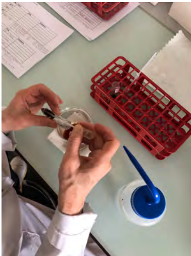
(a) Spülung der Probe mit destilliertem Wasser
