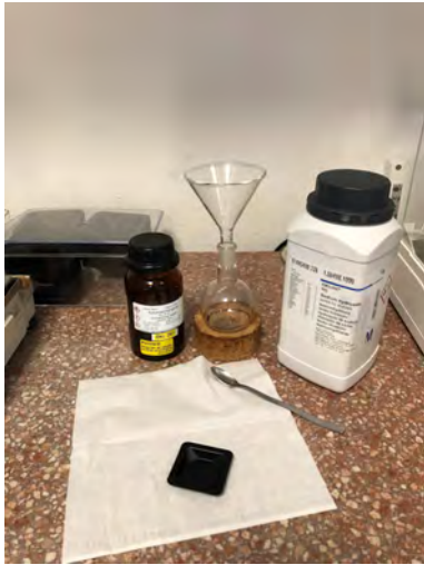
(a) Zugabe von Natriumhydroxid und Kaliumpermanganat
