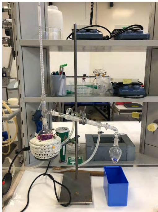
Abbildung 9: Aufbau der Destillation der Gewässerproben
