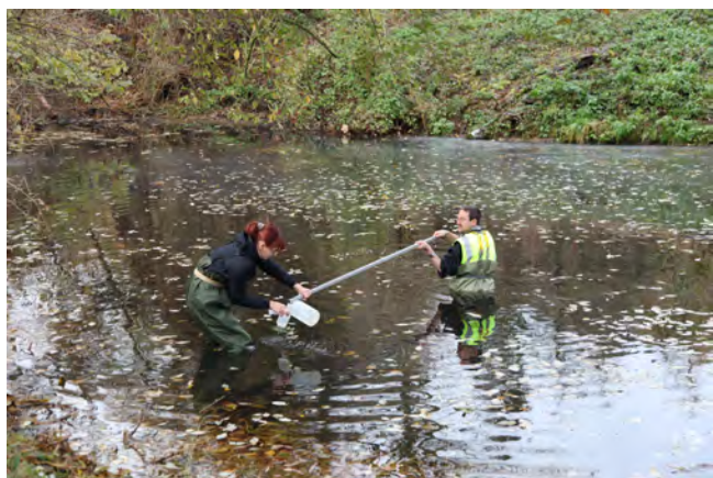
(a) Probenahme an UT: Umfüllen des entnommenen Wassers in das entsprechende Transportgefäß
