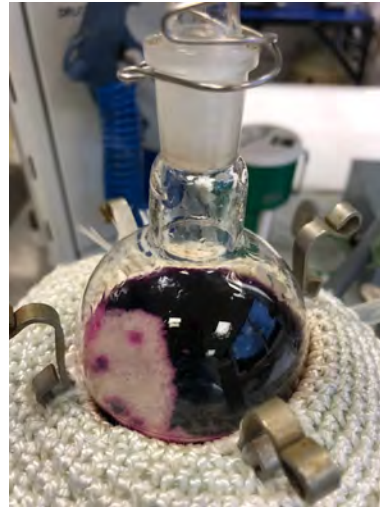
(b) Durch das Kaliumpermanganat tritt eine violette Verfärbung auf
