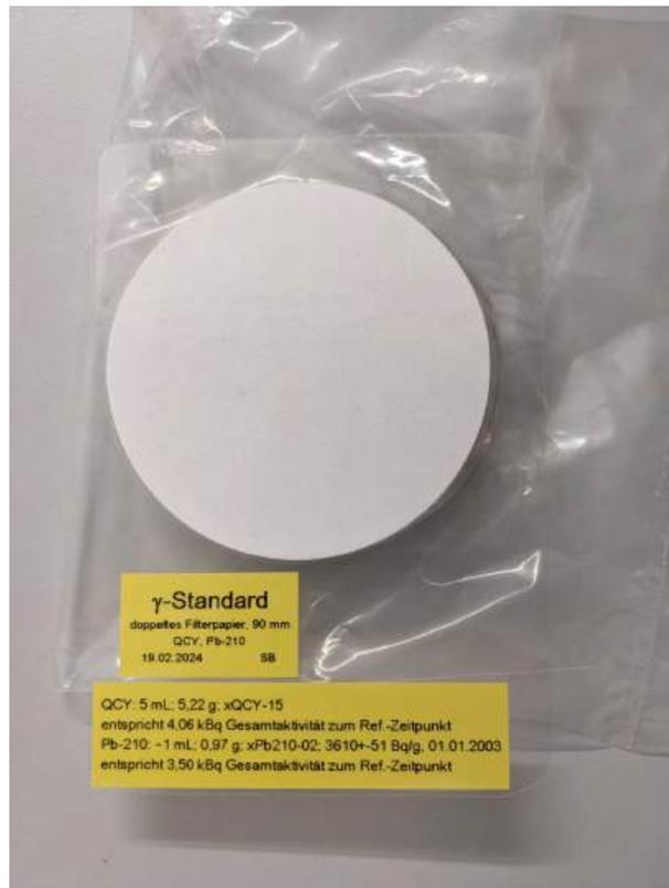
Abb. 15: Verwendeter Standard zur Effizienzbestimmung
