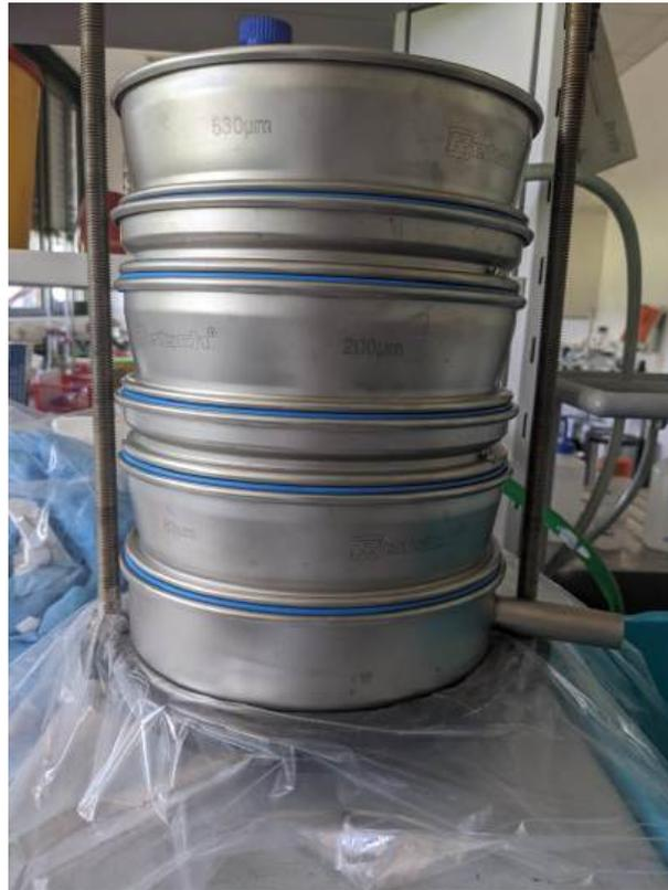
Abb. 12: Siebturm für die Separation der verschiedenen Sandkomponenten.
