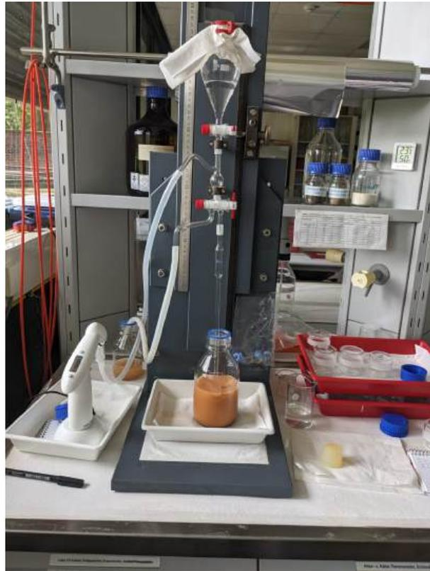
Abb. 11: Aufbau der Körnungspipette
