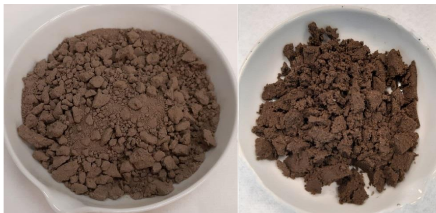
Abbildung 2.2: Verwendeter Referenzboden RefeSol 01-A im getrockneten (links) und wassergesättigten Zustand (rechts).
