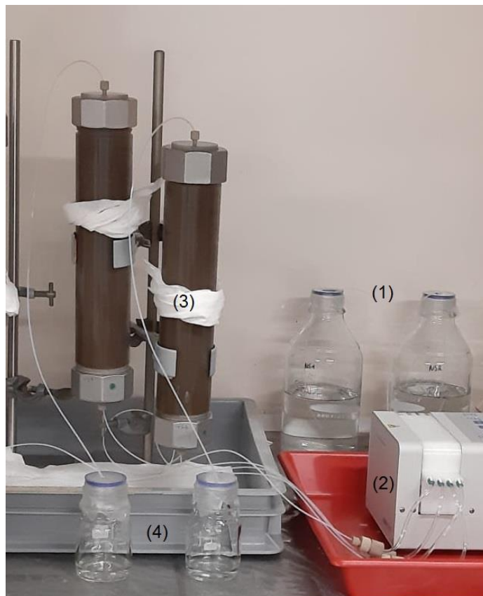
Abbildung 4.1: Aufbau der Säulen. Synthetisches Bodenwasser wird aus Vorratsgefäßen (1) von der Pumpe (2) von unten nach oben durch die Säulen (3) gepumpt und in Sammelgefäßen (4) aufgefangen.
