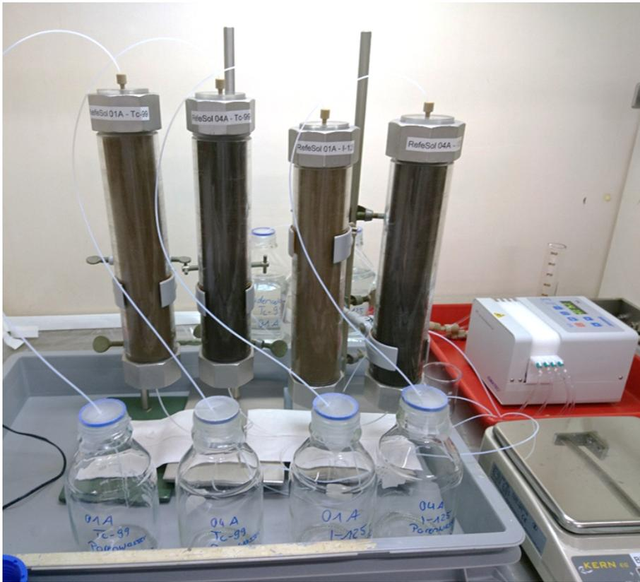
**Abbildung 3.6.: Aufbau der Säulenversuche - das Bodenwasser wird von unten durch die Säulen gepumpt und nach Durchlauf in Gefäßen gesammelt.**
