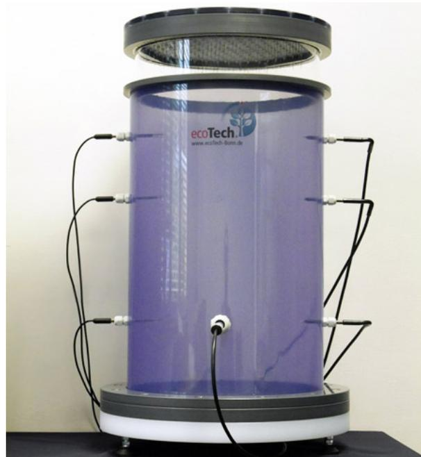
**Abbildung 3.7.: Aufbau eines Lysimeters der Firma ecoTech, ausgestattet mit einer Beregnungsplatte und eingebauten pH-Sonden [21].**
