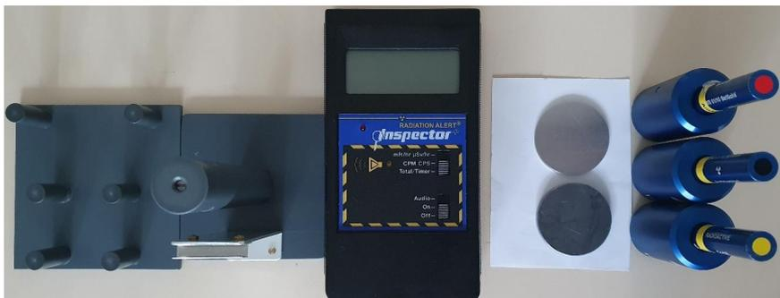
1 Am-241 Präparat, 1 Sr-90 Präparat, 1 Cs-137 Präparat, 1 Inspector, 1 Inspector-Halter,
