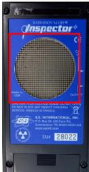
3. Die zu messende Probe auf das runde Zählrohrfenster des Inspectors legen
