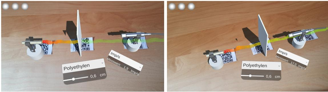
Abbildung 7: Identische Versuchsaufbauten für die Abschirmung von Betastrahlung zur Veranschaulichung der aufgetretenen Probleme. Links hat eine korrekte Messung stattfinden können. Rechts läuft der Strahl an der Abschirmung vorbei, wodurch die Messreihen unbrauchbar sind.
