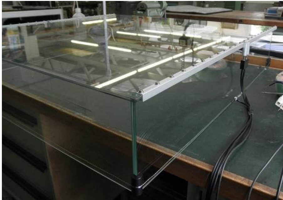
Abbildung 4.4.: Glashaube mit Heizdrähten
