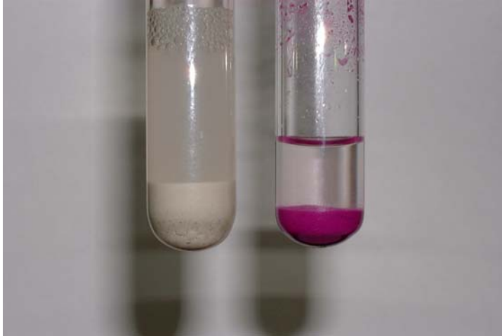
Abb. 3.12: Nachweis von Aldehyden mit dem Schiff'schen Reagenz. Links: unbestrahlter Ton; rechts: bestrahlter Ton mit Aldehyden.
