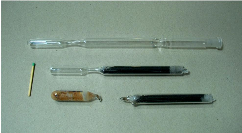
Abbildung A.4: Doppelampulle bei verschiedenen Bearbeitungsschritten
