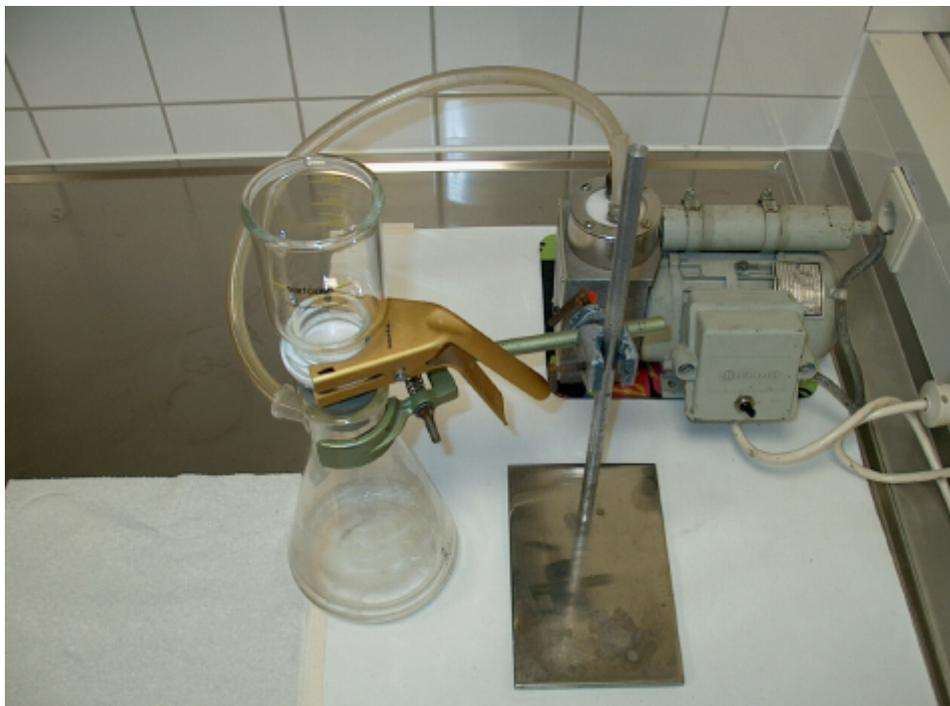
Abbildung A.7: Filtrationsapparatur
