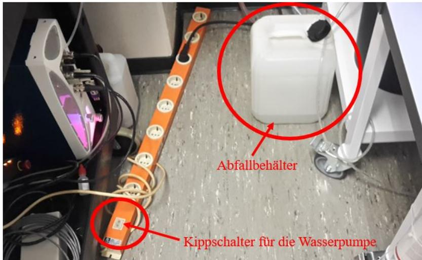
Abbildung 5.2: Position des Abfallbehälters und des Kippschalters für die Wasserpumpe.
