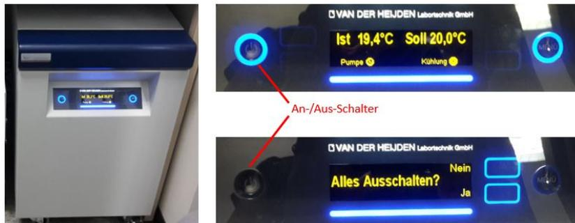
Abbildung 5.3: Wärmetauscher mit Bedienfeld (rechts).
