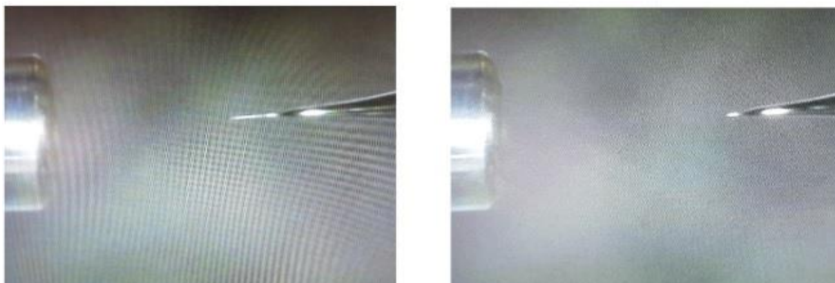
Abbildung 17: Nano-ESI Emitter, links: verschlossen; rechts: geöffnet. [42, bearbeitet]
