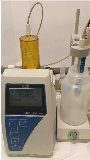
Abbildung 14: Versuchsaufbau der Thoriumhydroxid-Fällung.
