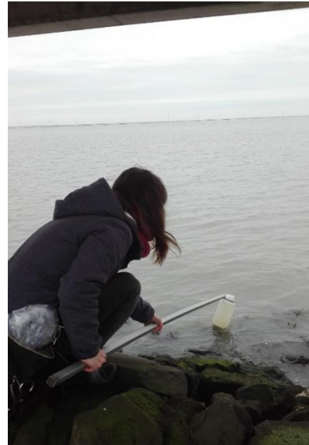
Abb. 12: Entnahme der Proben. Als Hilfsmittel wurde eine Metallstange benutzt, an deren Ende eine Kautexflasche befestigt ist.
