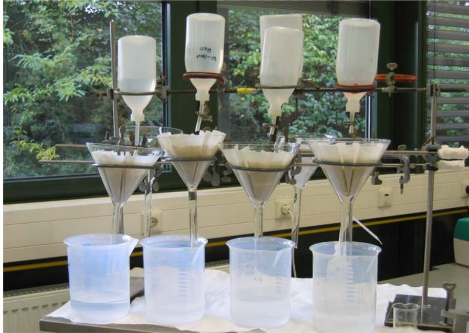
**Abbildung 7:** Spülvorgang bei der Herstellung von Organotone
