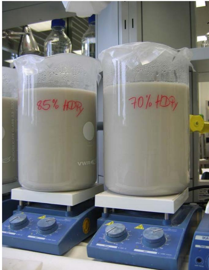
**Abbildung 6:** Rührvorgang bei der Herstellung von Organotone
