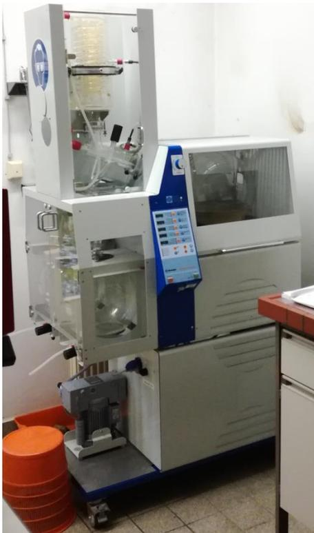
Abbildung 19 Der verwendete Rotationsverdampfer
