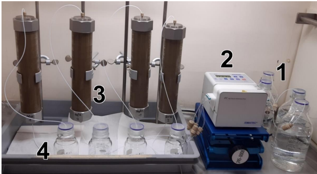
Abbildung 3-3: Versuchsaufbau des Säulenversuchs; aus Vorratsgefäßen (1) wurden die Bodenlösungen mittels einer peristaltischen Schlauchpumpe IPC-4 von ISMATEC (2) von unten in die Säulen (3) gepumpt. Das Eluat der Säulen wurde in Sammelgefäßen (4) aufgefangen.
