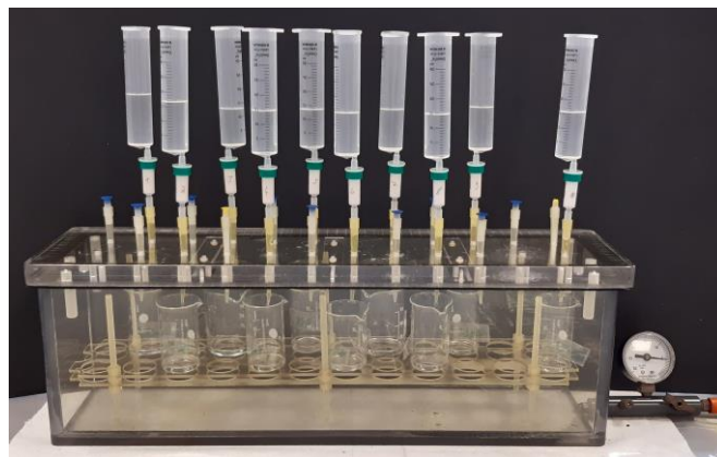
Abbildung 3-5: Aufbau der Extraktionschromatographie über TEVA-Harz mittels Vakuumbox.
