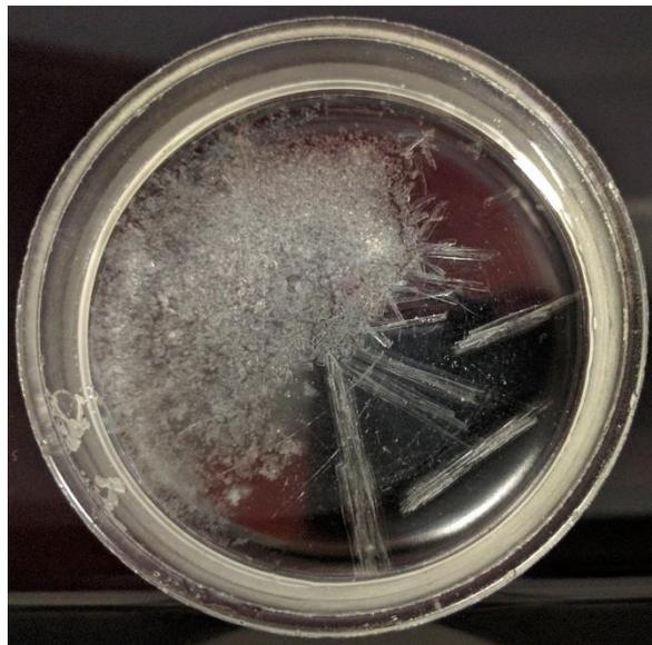
Noch bevor die Kristalle im Trockenschrank trocknen können, verlieren sie ihre Form. Nach Entnahme aus dem Trockenschrank bildet sich ein Wasserfilm, der die Kristalle teilweise wieder löst.
