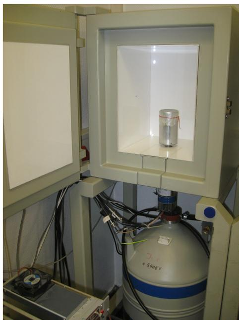
Abbildung 2.4.: Halbleiterdetektor mit offener Abschirmung
