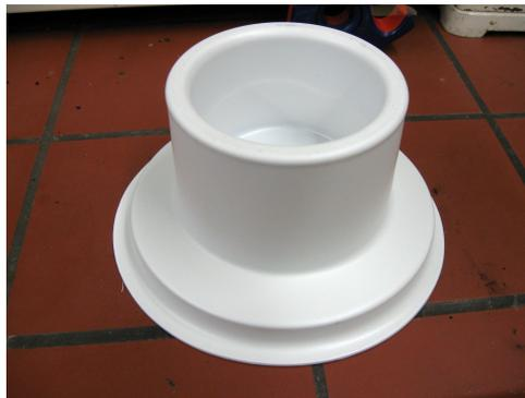
**Abbildung C.1.:** Ringschale (Marinellibecher) von unten. Die Messgeometrie dieser Schale bietet eine große Probenoberfläche und damit eine effiziente Messung.
