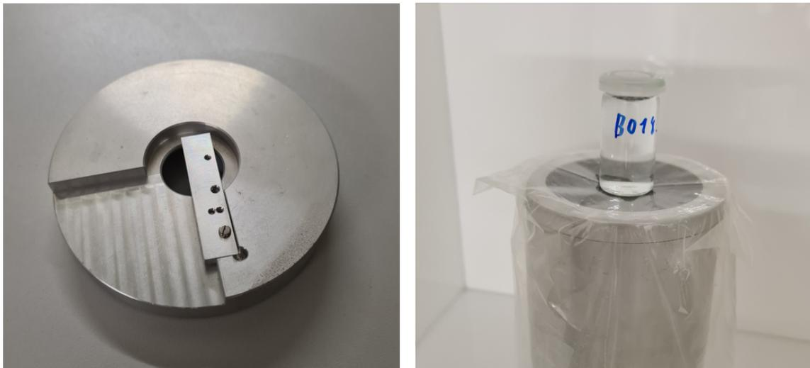
Abb. 23: Spezialadapter für die Aufnahme der Nadelhalter zum Messen der Partikel und Lösung auf dem Gammadetektor.
