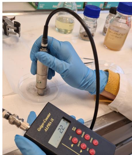
Abb. 17: Mit dem GMZ wird das Filterpapier nach Aktivität abgesucht.
