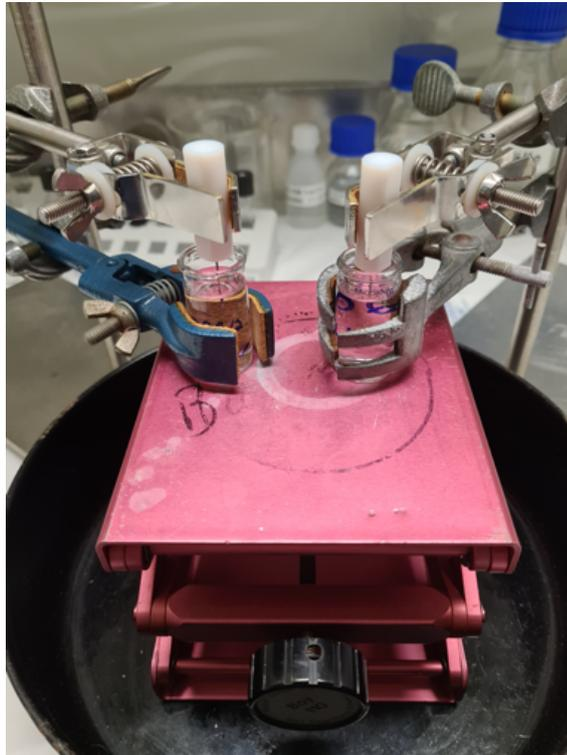
Abb. 21: Versuchsaufbau der sequentiellen Auslaugung.
