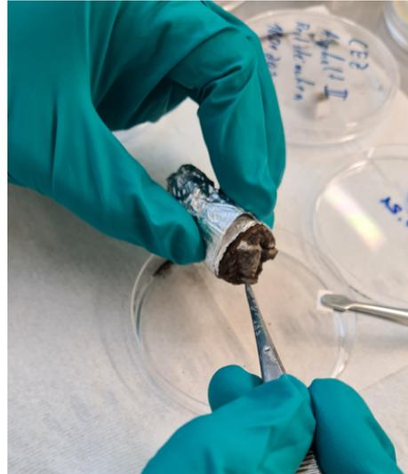
Abb. 16: Mit der Pinzette wird Material vom Bohrkern abgetragen.
