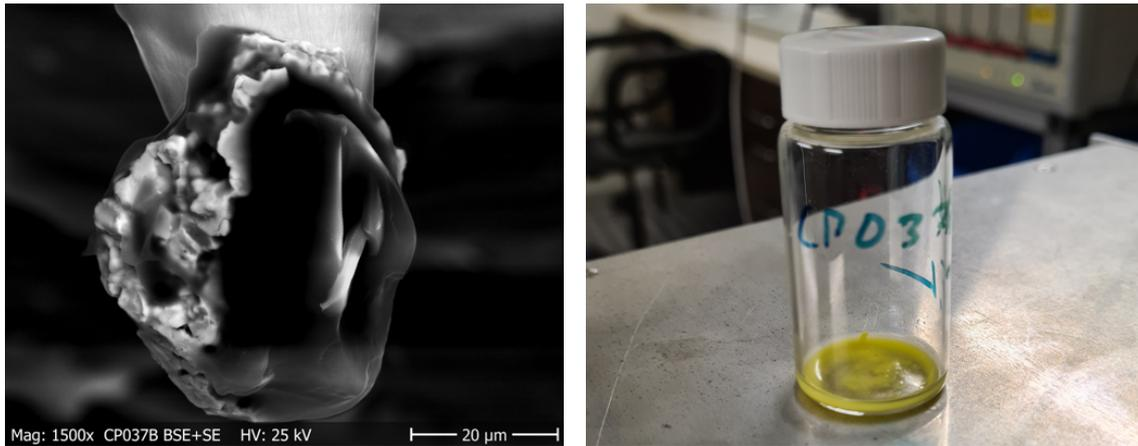
Abb. 39: BSE+SE-Aufnahme von LokiB vor dem Auflösen und gelber Wolframoxid-Niederschlag in  $\text{HNO}_3$ . LokiB war durch die mehreren (Re-)Extraktionen sichtlich verklebt.
