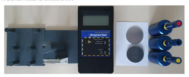
1 Am-241 Präparat, 1 Sr-90 Präparat, 1 Cs-137 Präparat, 1 Inspector, 1 Inspector-Halter, 1 Blatt Papier, Aluminium-Platten, Blei-Platte
