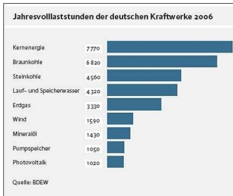
Abbildung 12.5: Jahresvolllaststunden deutscher Kraftwerke 2006 [www.bdew.de]
