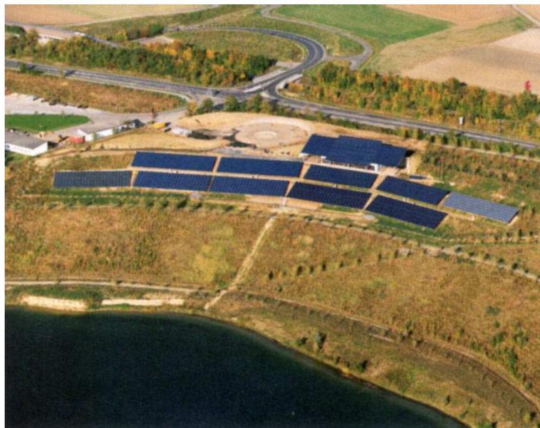
Abbildung 8.23: Solarkraftwerk Neurathersee mit 360 kWp Leistung [4]
