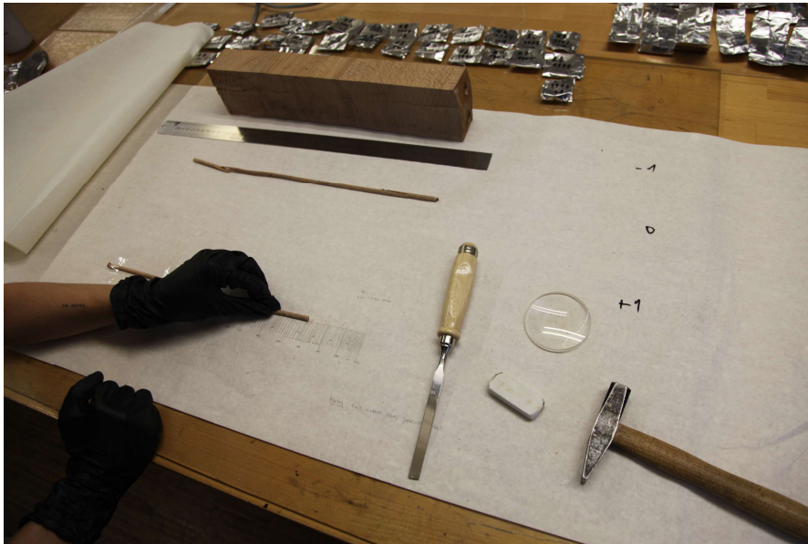
196 197 Abbildung 4: Dendrochronologische Zuordnung und Entnahme der Baumringe aus Bohrkerne der Rotbuche.
