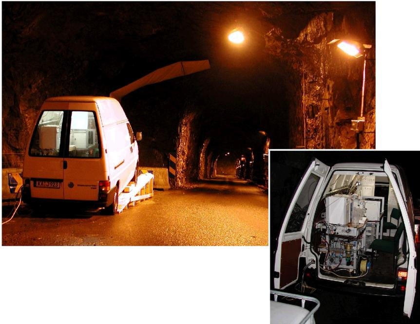
**Abbildung 7.13:** Mobile LIBD Anlage zur *in-situ* Detektion von Kolloiden [Haus02]. Bei der Untersuchung von Tiefenwässern die unter hohem Druck und Sauerstoffausschluß stehen ist eine *in-situ* Messung unumgänglich, da Drucksenkung oder Sauerstoffzufuhr zur Bildung zusätzlicher Kolloide führt. Hier gezeigt ist eine Meßkampagne im Untertagelabor Äspö (Schweden) [Haus03, Walt03b]
