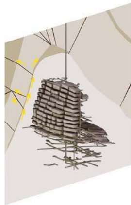
b) Mögliche Transportwege kontaminierter Salzlösung
