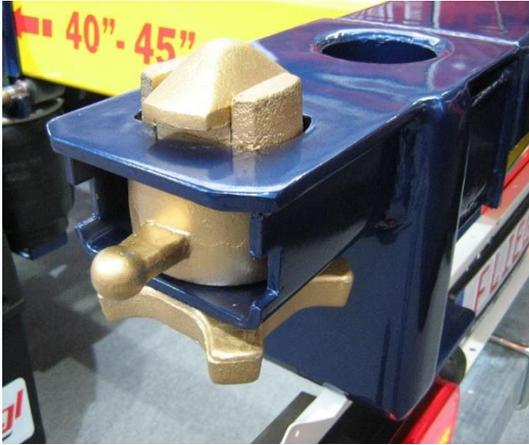
**Abbildung 11: Formschlüssige Lastaufnahmeeinrichtung (Twist-Lock) [75]**
