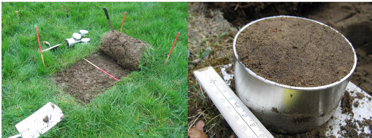
Abb. 3.6: Entnahme von Stechzylinderproben.
