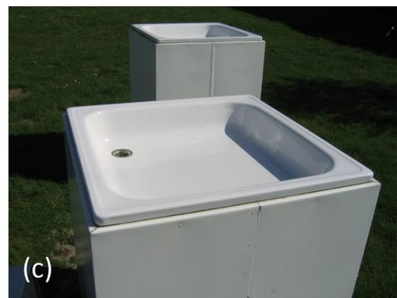
Abb. 3.2: (a) Schematische Darstellung der Niederschlagssammler an den Radioaktivitätsmessstellen des DWD [FS, 2010]; (b, c) Sammler an der Messstelle in Hannover-Langenhagen.
