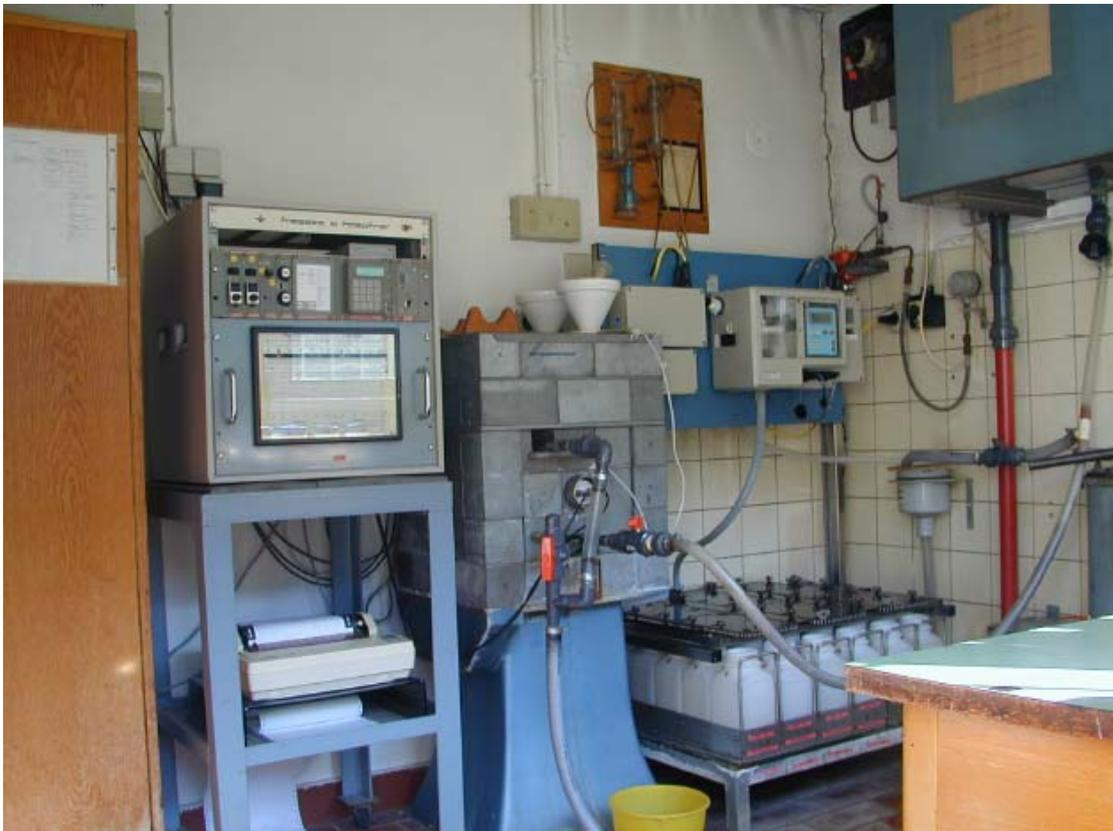
Abb. 3.3: Automatische Fließgewässer-Probenahme (Radioaktivitätsmessstation der BfG in Rockenau/Neckar) [Dersch 2006].
