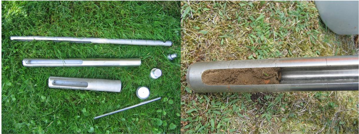
Abb. 3.4: Verwendete Bohrstöcke.
