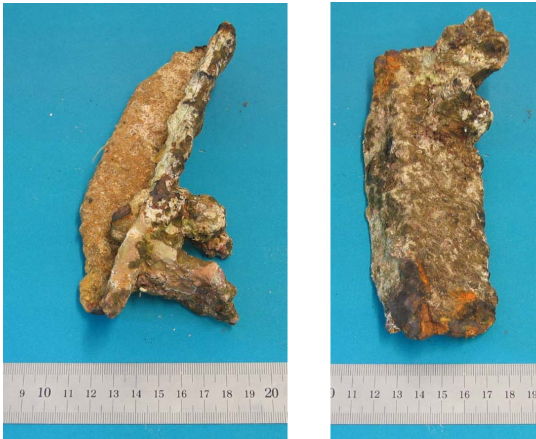
Abbildung 5: Zwei Ansichten des Winkeleisens der PRINZ EUGEN
